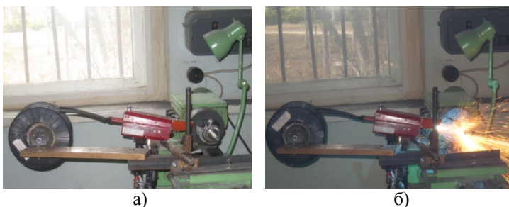
Рисунок 3 – Процесс ЭДМ: а) – подготовка к процессу металлизации коленчатого вала, б) – нанесение ЭДМ-покрытия на коленчатый вал
