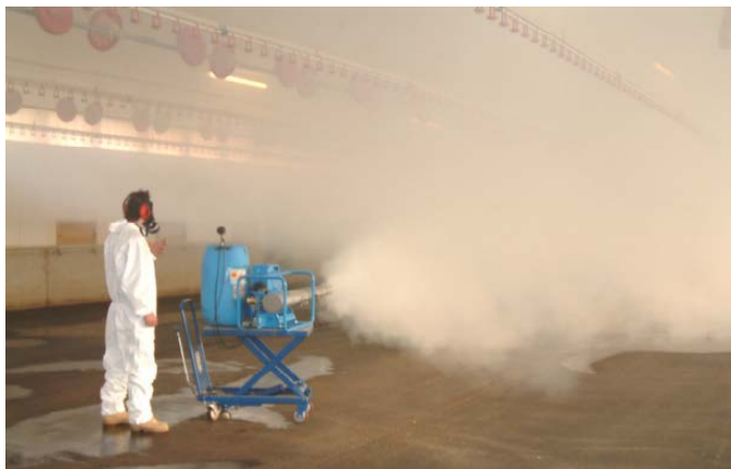
Рисунок 6 - Обработка помещения при помощи стационарного генератора горячего тумана
